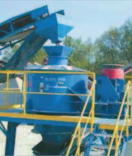
Pionowa kruszarka udarowa ODV 1186M - kruszenie żwiru
