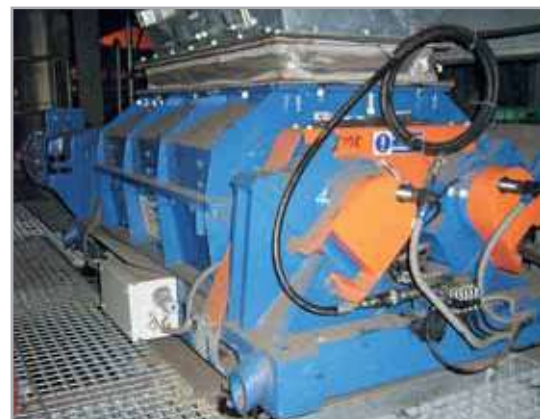
Kruszarka DVR 18 kruszenie żużla 12 t/h
