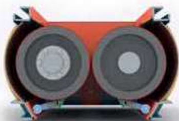
Przekrój przez kruszarkę DVU do delikatnego kruszenia
