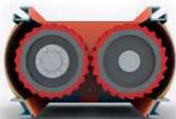
Przekrój przez kruszarkę DVU do średnio grubego kruszenia
