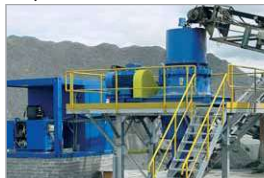
Kruszarka stożkowa KDC 33 JP – kruszenie spilitu
