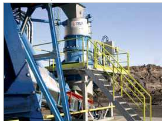
Kruszarka stożkowa KDC 23 HP – kruszenie żużla
